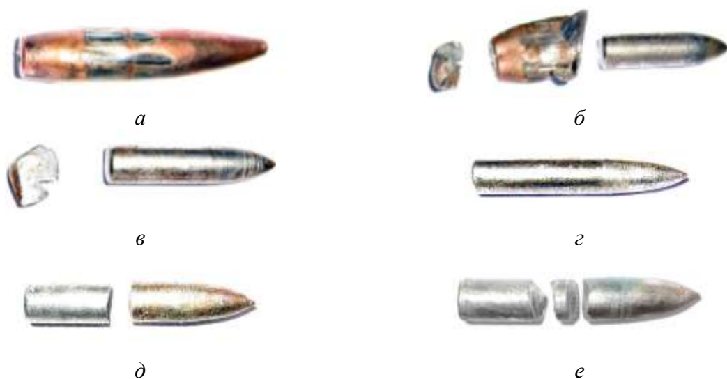
Fig. 2. Вигляд деформованих куль 7,62 Б-32 після пробиття перешкод: а – 1 мм Ст3; б – 3 мм Ст3; в – 4,5 мм Ст3; г – 5 мм 2П; д – 6,5 мм 2П; е – 10 мм 2П
