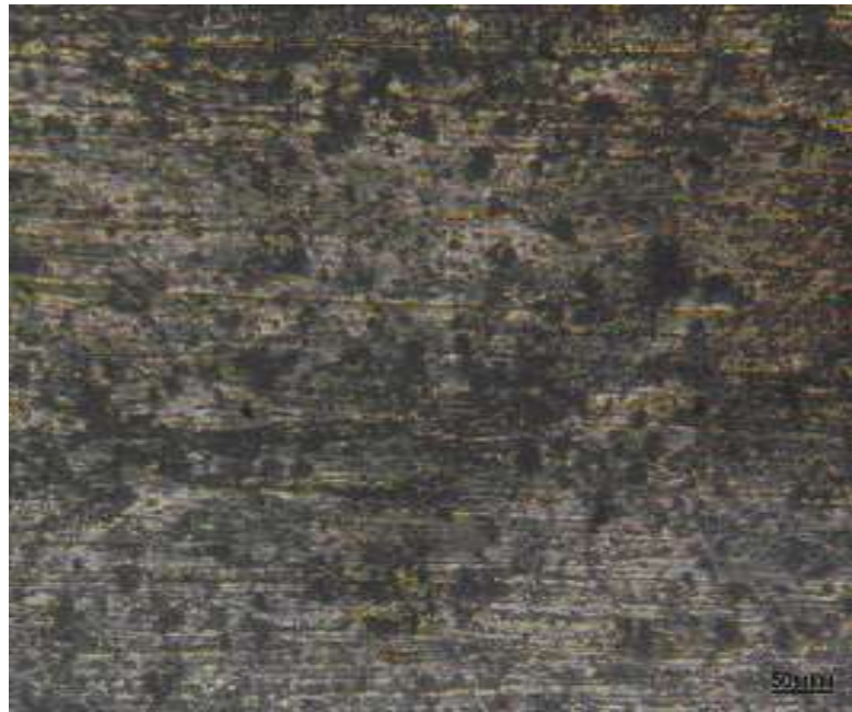
Рисунок. Поверхность покрытия после испытания на абразивный износ.
