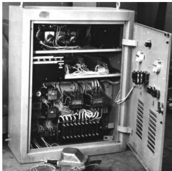
Рисунок 1. Устройство для динамического торможения крановых механизмов:
