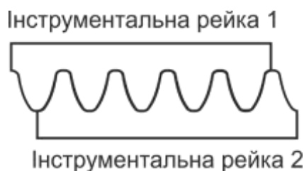
Рисунок 1. Інструментальні рейки зі зворотними профілями бічних поверхонь зубів
