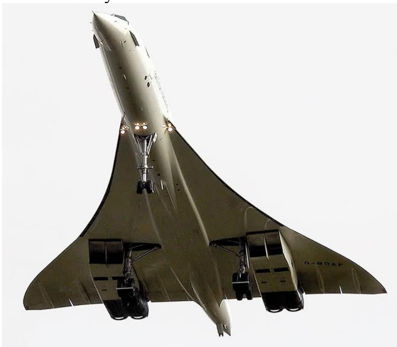
Рисунок 4. Пример аэродинамической схемы бесхвостка (Concorde 216)
