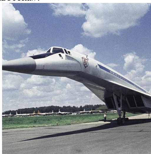
Рисунок 5,6. Конвертируемая аэродинамическая схема (Ту-144)
