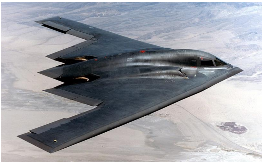
Рисунок 4. Пример аэродинамической схемы летающее крыло (Northrop B-2 Spirit)
