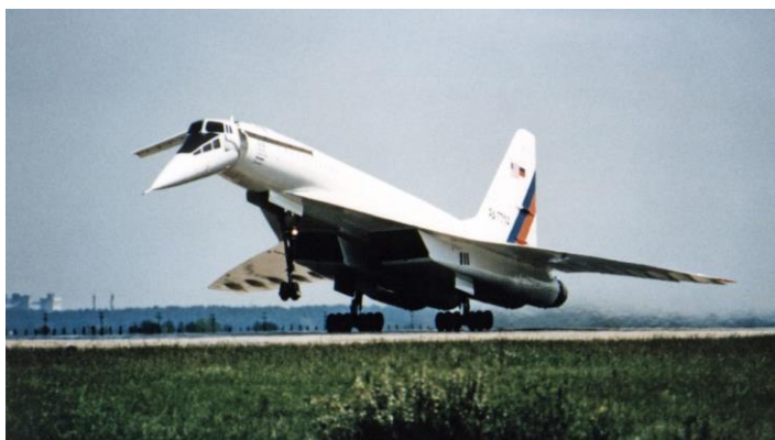
Рисунок 5,6. Конвертируемая аэродинамическая схема (Ту-144)
