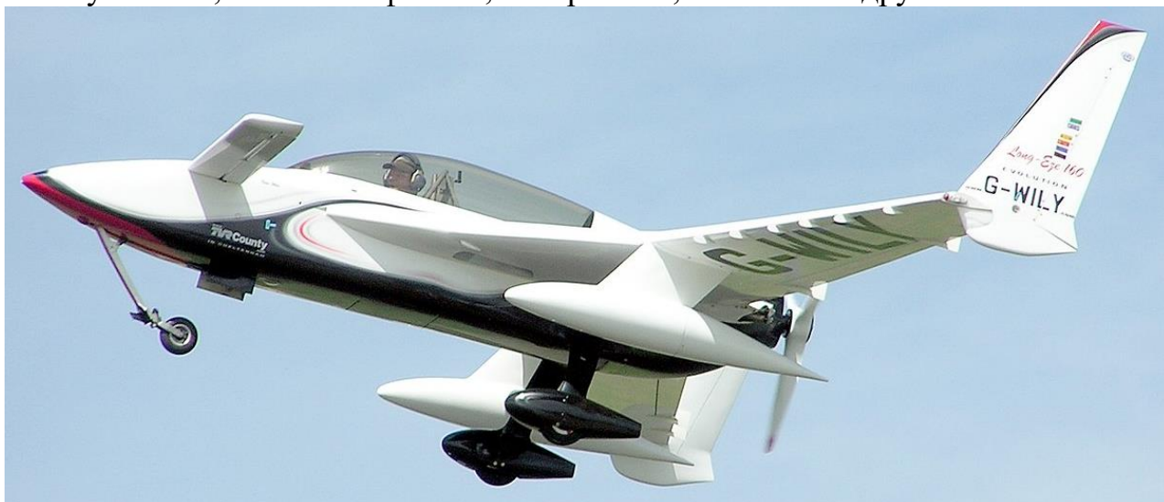
Рисунок 2. Пример аэродинамической схемы утка (Rutan Model 61 Long-EZ)
