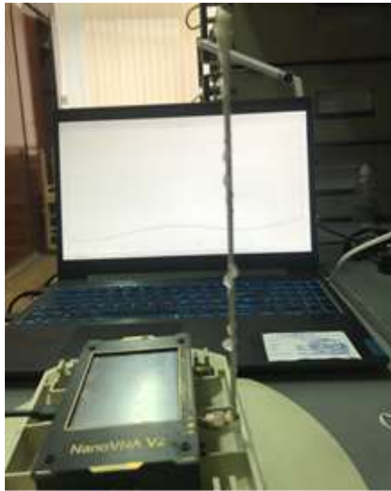
Рисунок 2. Измерение импедансных характеристик штыревой антенны канала управления
