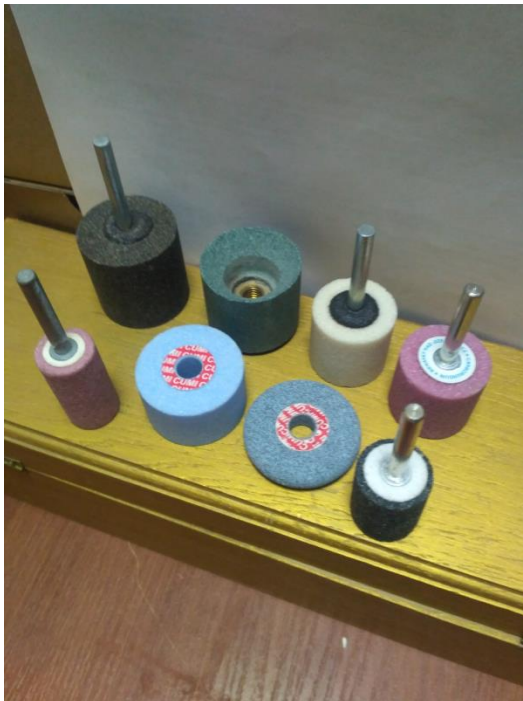
Рисунок 1. Образцы шлифовальных головок из различных абразивных материалов
