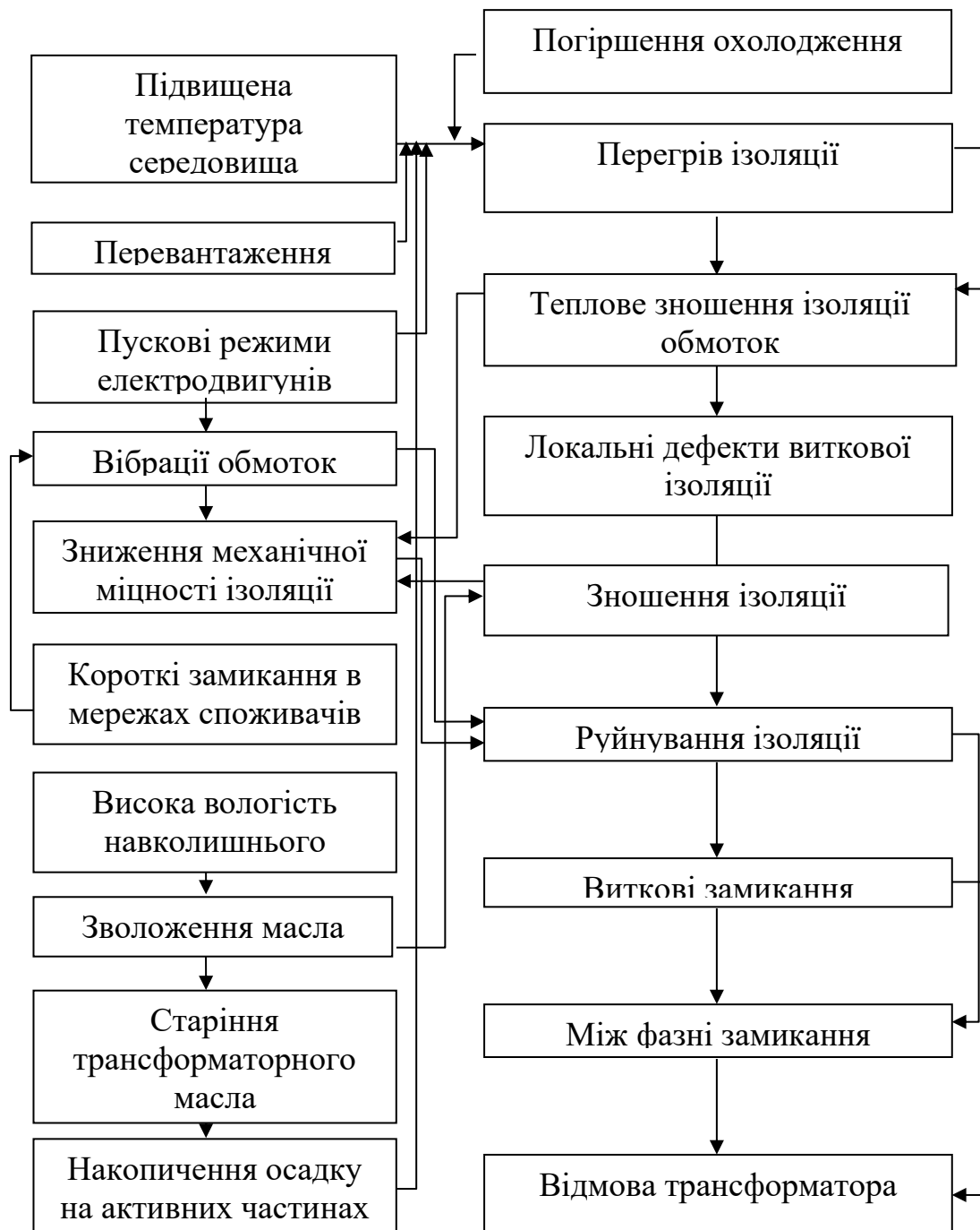
Рисунок 1 – Блок-схема пошкоджень елементів конструкції силових трансформаторів
