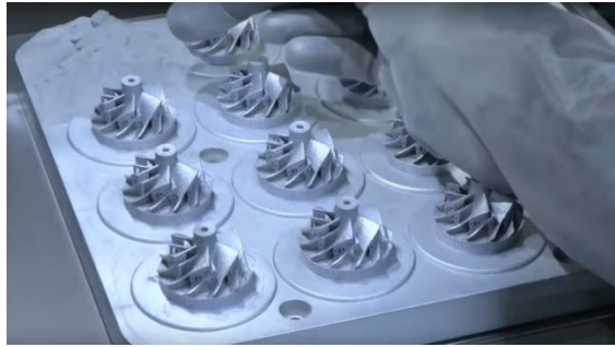
Рисунок 8. Очищення надрукованих відцентрових крильчаток від порошку
