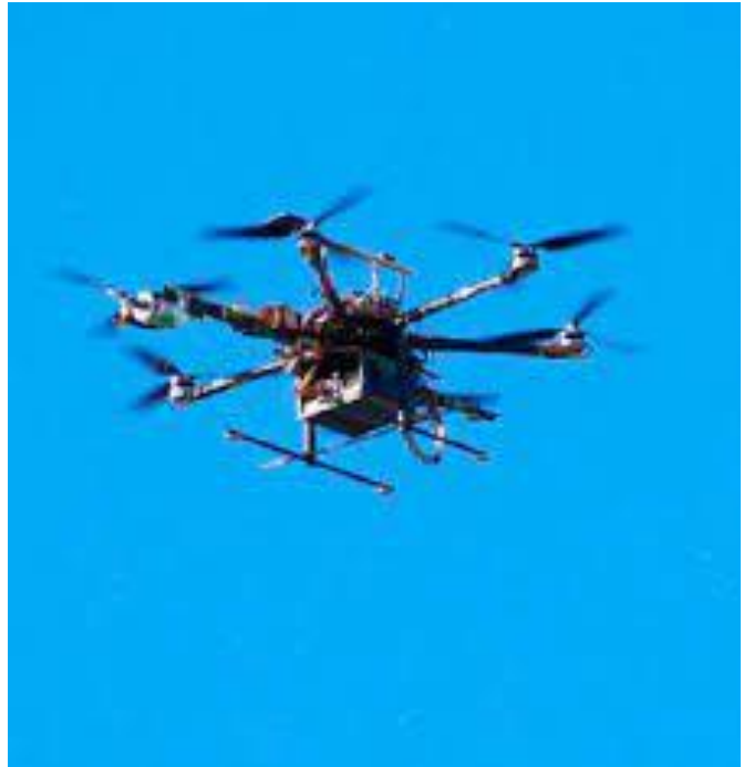
Рис. 3. Розміщення ретранслятора радіосигналів на БПАК
