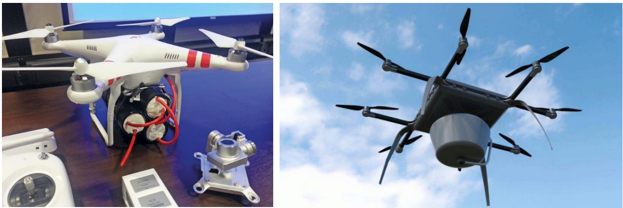
Рис. 2. Безпілотні роботизовані комплекси різних типів, переобладнані у носії ретранслятора радіосигналів
