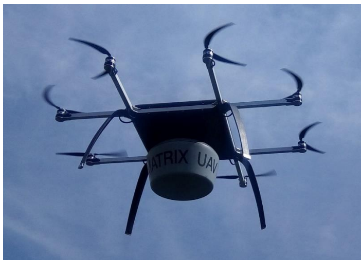
Рис. 1. Варіант розміщення ретранслятора на БПЛА.
