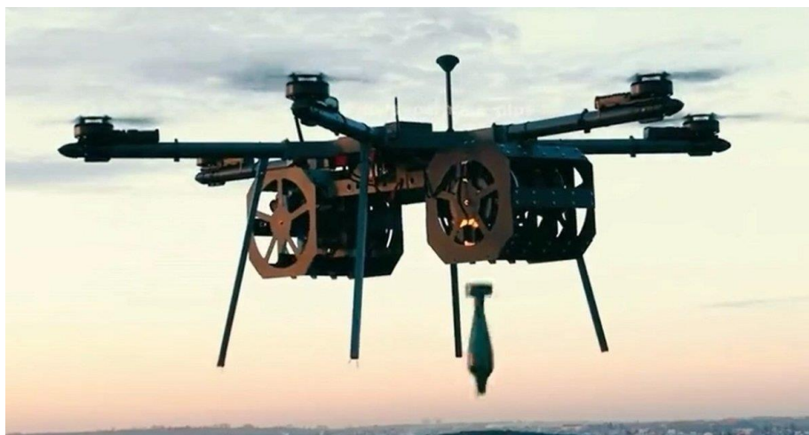
Рис. 7. Дрон оснащений спеціальними спусковими пристроями, здатними скидати мінометні міни
