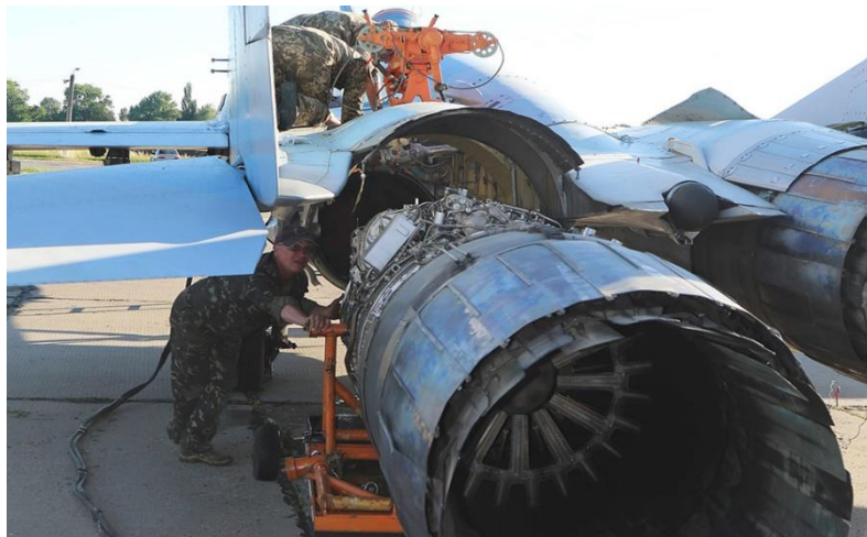
Рис. 3. Часткове розбирання АТ для доступу до систем і агрегатів
