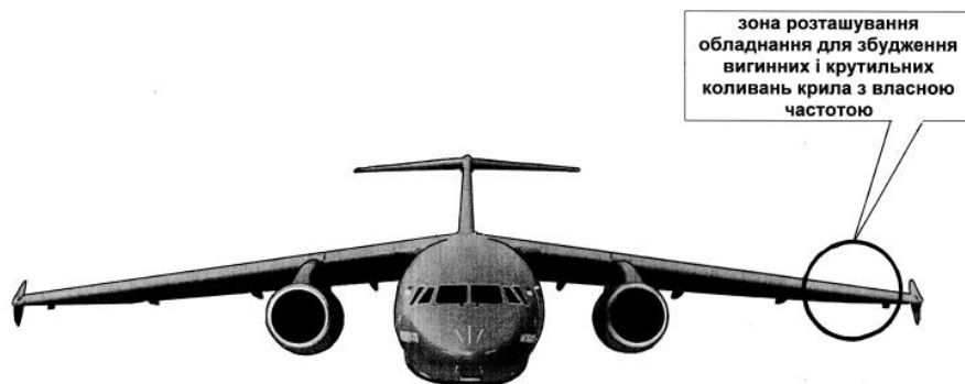
Рис. 8. Схема розташування гіроскопу в районі закінцівки крила літака.
