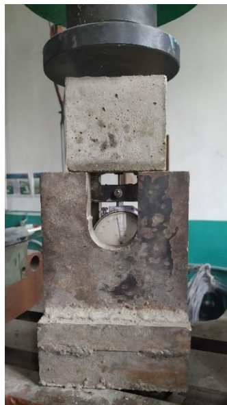
Рисунок 2. Загальний вигляд установки для випробування зразків на вдавлювання
