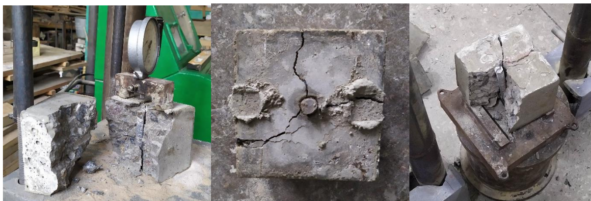
Рисунок 4. Характер руйнування зразків за дії навантажень: а) статичних методом висмикування; б) статичних методом вдавлювання; в) динамічних.
