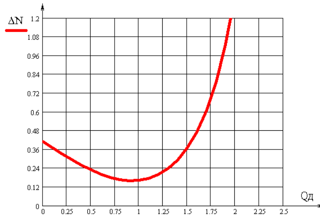
Рисунок 3. Характеристика втрат потужності насоса ВН
