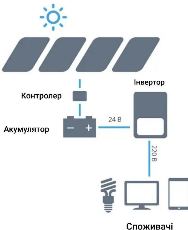
Рисунок 2 - схема автономної СЕС
