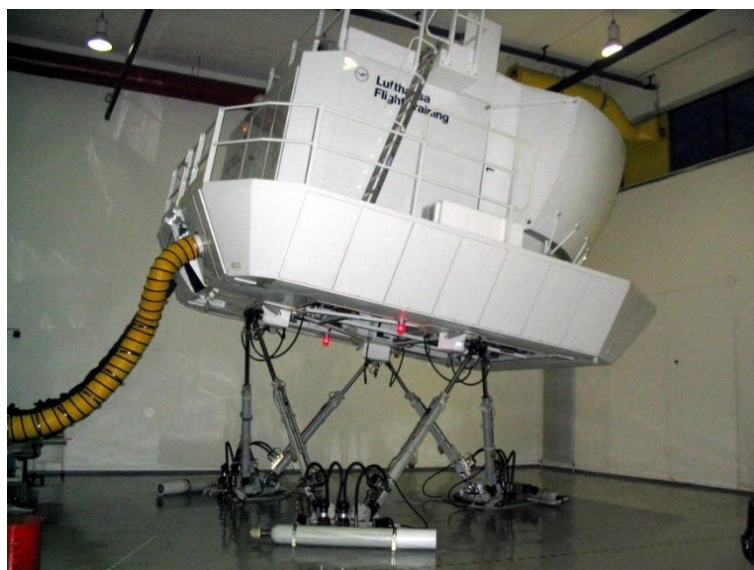
Рис. 1. Комплексний авіаційний тренажер з системою рухомості на шість ступенів свободи.
