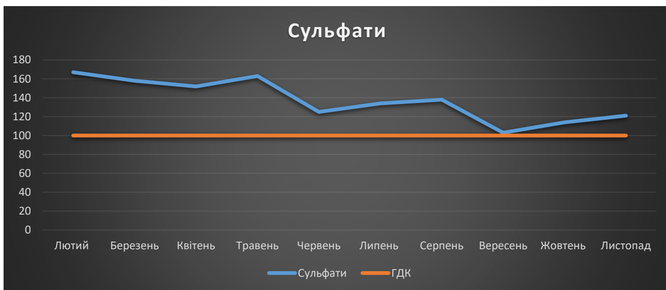
Рис.1. Перевищення ГДК сульфатами в річці Сіверський Донець в пункті спостереження Печенізьке водосховище с. Печеніги у 2023 році
