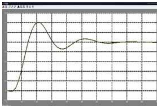
Рис.6. Перехідний процес одноконтурної системи керування з ПД-регулятором
