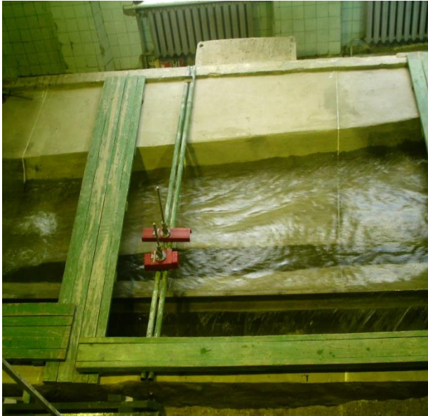
Рис. 3. Гідравлічні лабораторні дослідження бокового водозабору протипаводкової ємкості на р. Бистриця біля с. Тершаків у Львівській обл.
