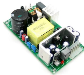
Рис. 4. Конструктивне виконання джерела живлення
