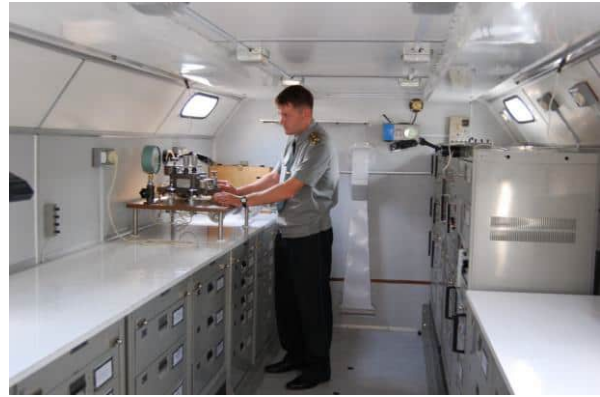
Рис. 5. Розміщення обладнання в кунзі пересувної лабораторії вимірювальної техніки УА2-4/А на базі автомобіля МАЗ
