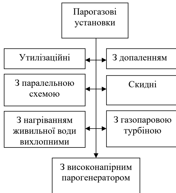
Рис. 1. Класифікація ПГУ за призначенням та за способами утилізації теплової енергії вихідних газів ГТУ
