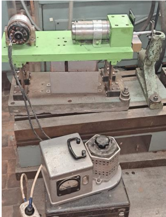
Рисунок 1 – Зовнішній вигляд стану для збудження механічних коливань при реєстрації дефектів у неметалевих гетерогенних матеріалах
