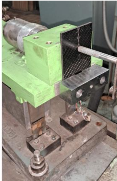
Рисунок 1 – Досліджувана пластина, закріплена на експериментальному стенді
