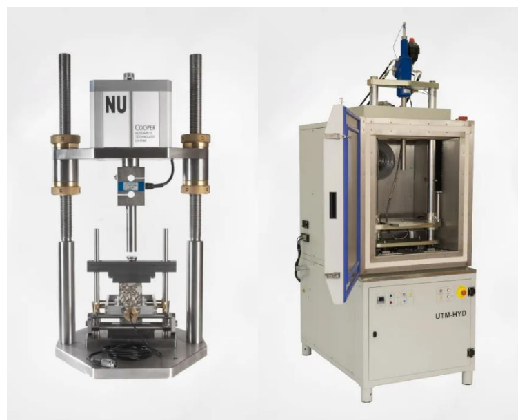
ნახ. 2. მოწყობილობები დაღლილობითი სიმტკიცის განსაზღვრისათვის, სტანდარტი (EN 12697-24)
