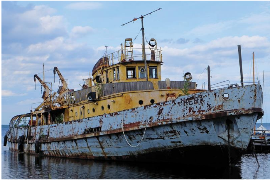
Рисунок 2 – Морська корозія в дії. Загальний вигляд судна
