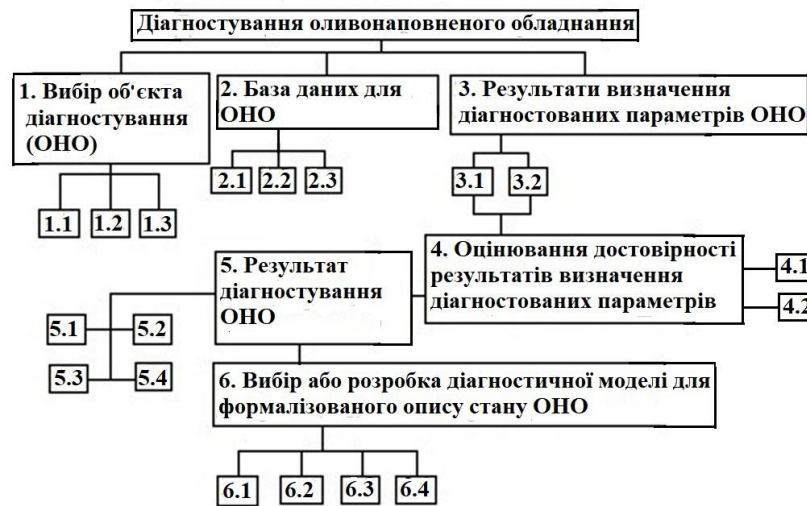
Рис. 4. Принципова схема процесу діагностування ОНО АЕС за результатами контролю властивостей проб ТС: 1.1 – вибір діагностичного забезпечення; 1.2 – вибір засобів діагностування ОНО; 1.3 – вибір алгоритму діагностування ОНО; 2.1 – технічний стан ОНО; 2.2 – місце відбору проб ТС із ОНО; 2.3 – нормативні показники: якості для ТС; діагностованих параметрів для ОНО; 3.1 – відповідність встановленим нормам для ТС та ОНО; 3.2 – невідповідність встановленим нормам для ТС та ОНО; 4.1 – ступень об'єктивної відповідності діагнозу дійсному технічному стану ОНО; 4.2 – ступень об'єктивної відповідності результату прогнозування технічному стану ОНО; 5.1 – результат визначення виду стану ТС в ОНО та стану ОНО; 5.2 – результат визначення можливих причин зміну стану ТС в ОНО та стану ОНО; 5.3 – результат прогнозування стану ТС в ОНО та стану ОНО; 5.4 – висновок про результат діагностування ОНО; 6.1 – аналітичний опис стану ОНО; 6.2 – табличний опис стану ОНО; 6.3 – графічний опис стану ОНО; 6.4 – інші форми опису стану ОНО.
