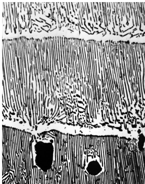
Рисунок 3. Структурні зміни на фронті росту аустенітно-карбідних колоній при термоциклюванні; \times 630
