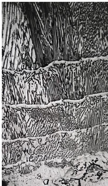
Рисунок 1. Мікроструктура дифузійного шару зразка сталі X20, науглецюваного у вакуумі при термоциклюванні з амплітудою від 950 °С до 1050 °С (4 цикли), загальний час науглецювання – 70 хвилин; x400
